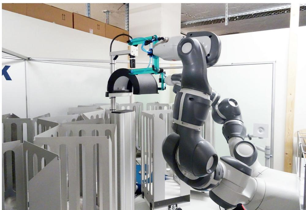
sorik im Prozess implementiert, um ein positionsgenaues Greifen und Ablegen der Katheter zu gewährleisten.
