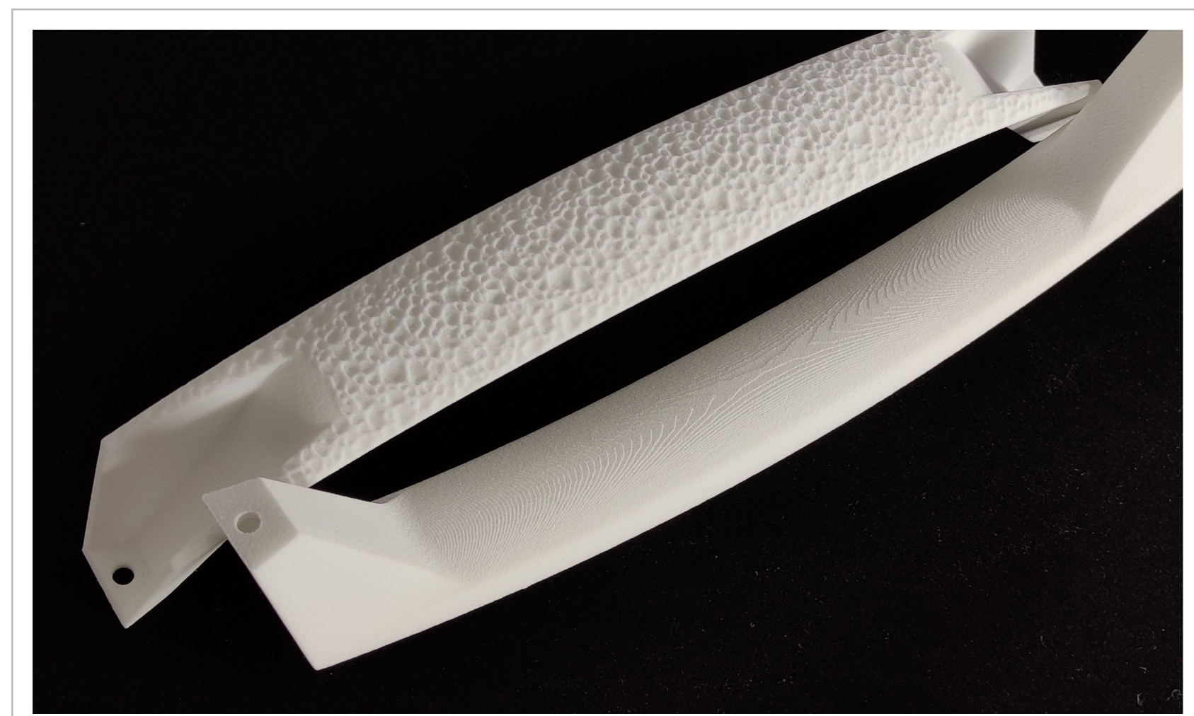
2 | Oben: Texturierte Oberseite eines SLS-Bauteils; Unten: Unterseite ohne Textur mit deutlich sichtbaren Treppenstufen
