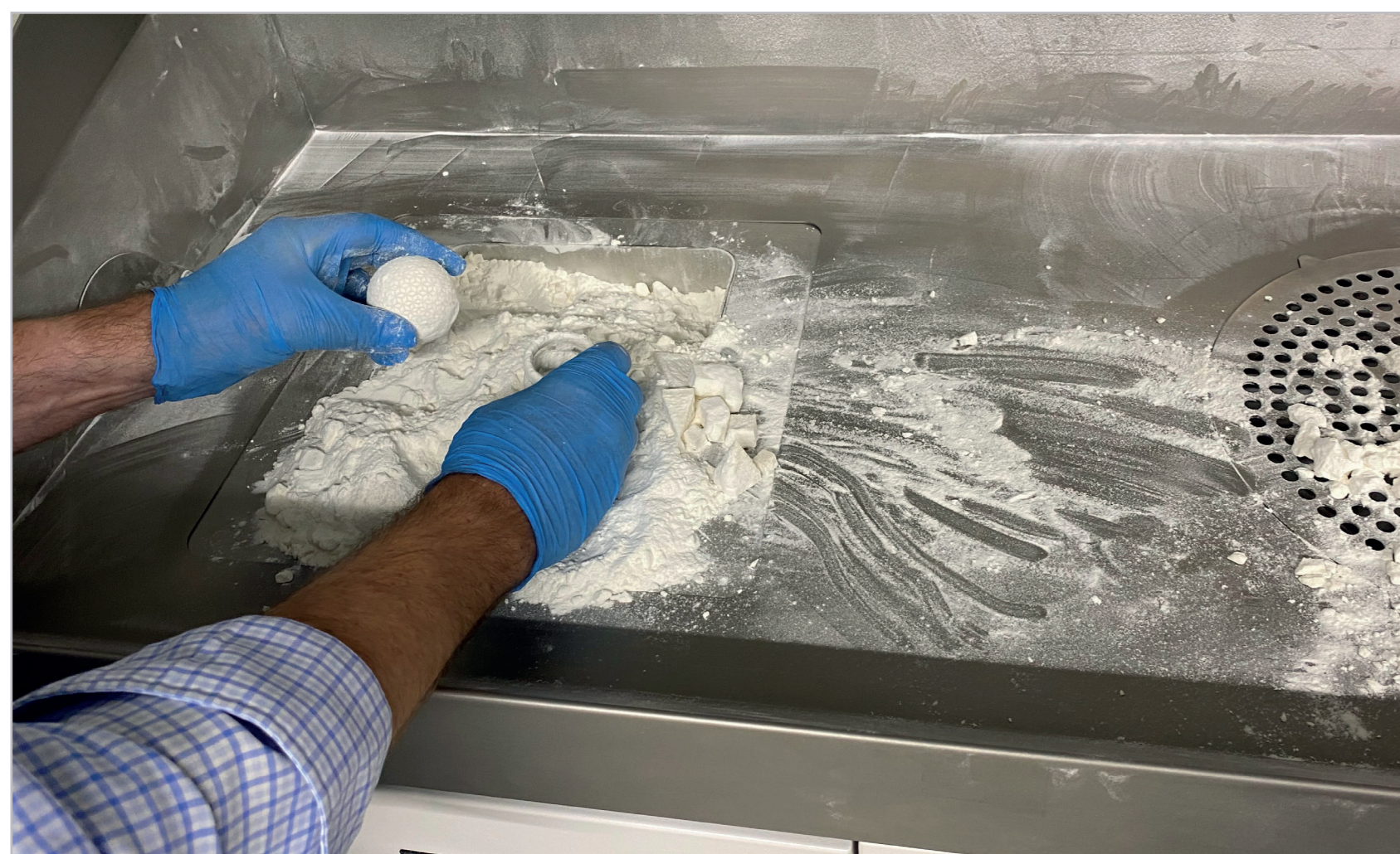
3 | Nach dem Auspacken der Teile aus dem Pulverkuchen wird ein Grossteil des Altpulvers wiederverwendet.
