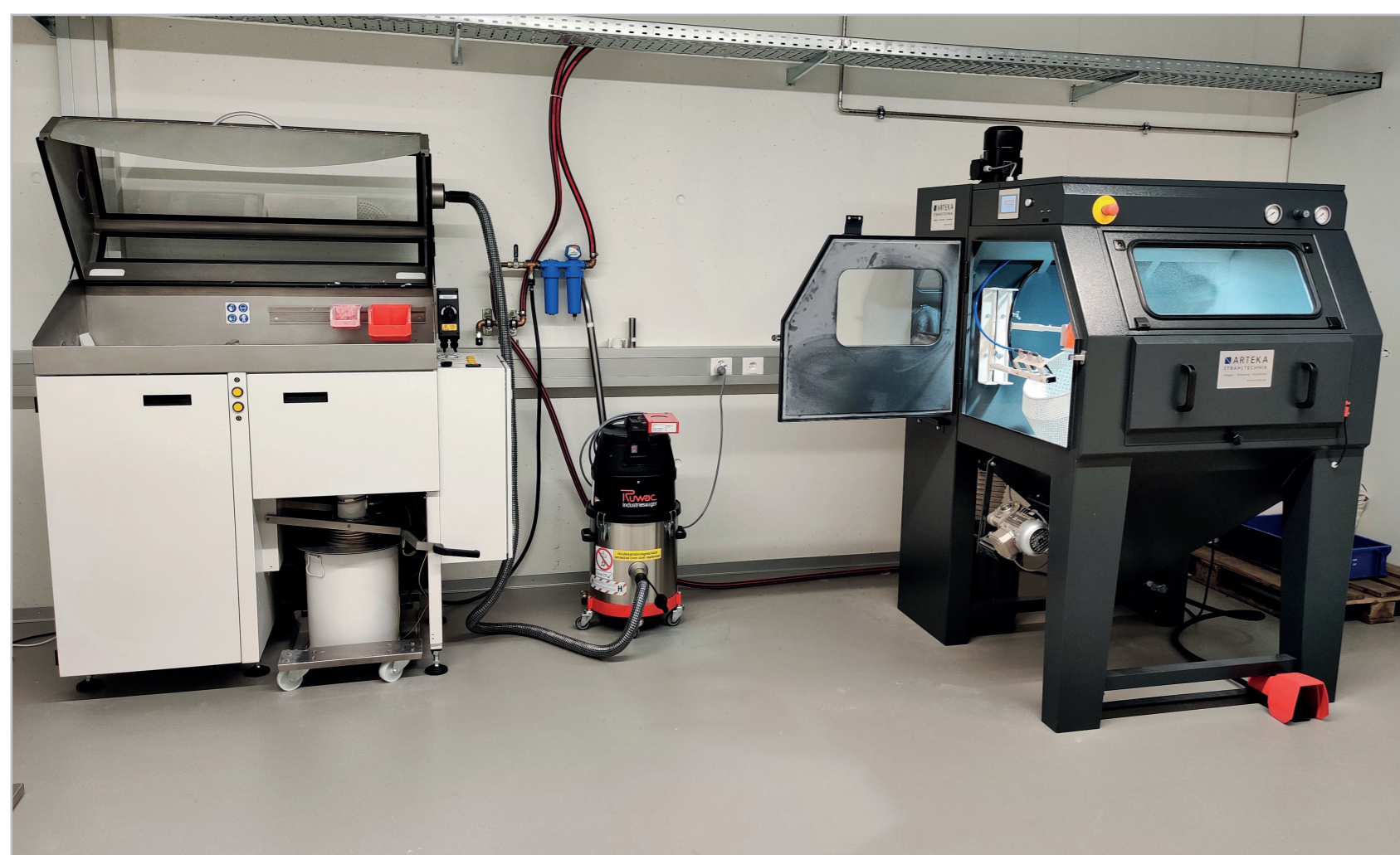
2 | Links: Auspack- und Siebstation P3 von EOS Rechts: Strahlkabine mit Drehtrommel für automatisiertes Strahlen von ARTEKA
