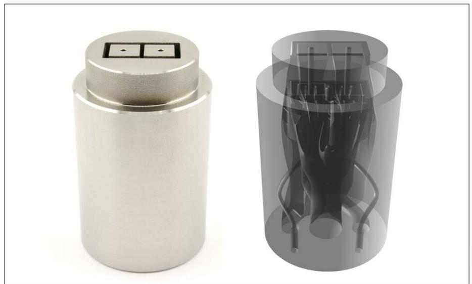
Co-Extrusionsdüse mit komplexer Kanalgeometrie, hergestellt aus Edelstahl unter Nutzung des additiven Fertigungsverfahrens des selektiven Laserstrahlschmelzens.
