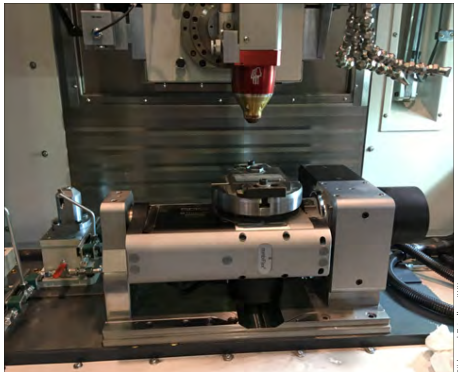
Bild 1: Hybridmaschine mit eingebautem LMD-System.
