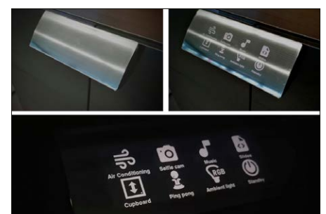
Bild 2: Versuchsblende an Vitrine montiert in ein- und ausgeschaltetem Zustand
