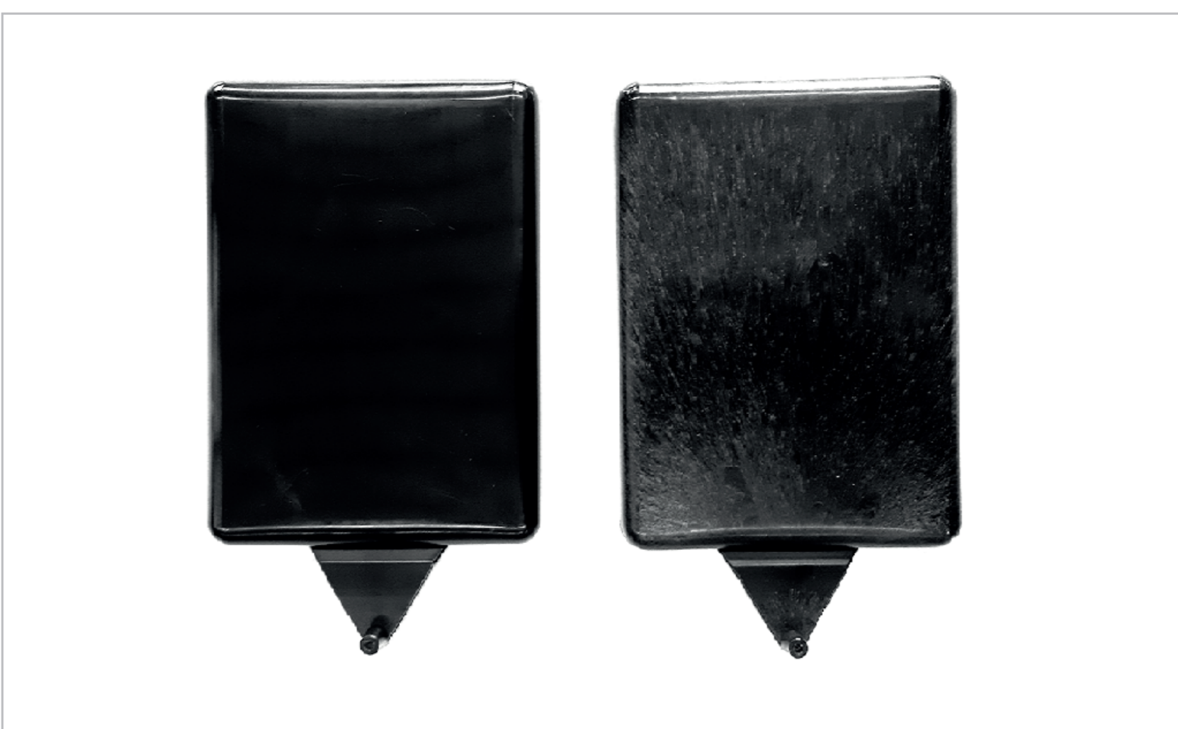
3 | Verbesserung der Bauteiloberfläche durch den Einsatz von Gasgegendruck
