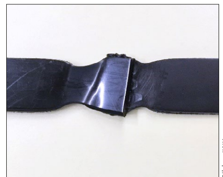
Bild 2: Versagen im Grundwerkstoff einer induktionsgeschweissten Zugscherprobe.
