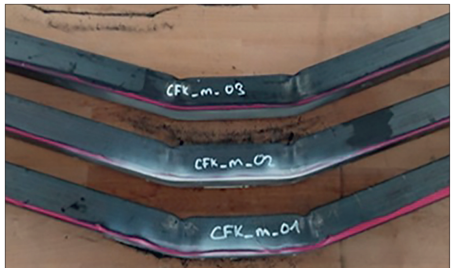
Abb. 4: Geknickte Profile mit verklebten CFK Lamellen nach den 4-Punkt-Biegeversuchen
