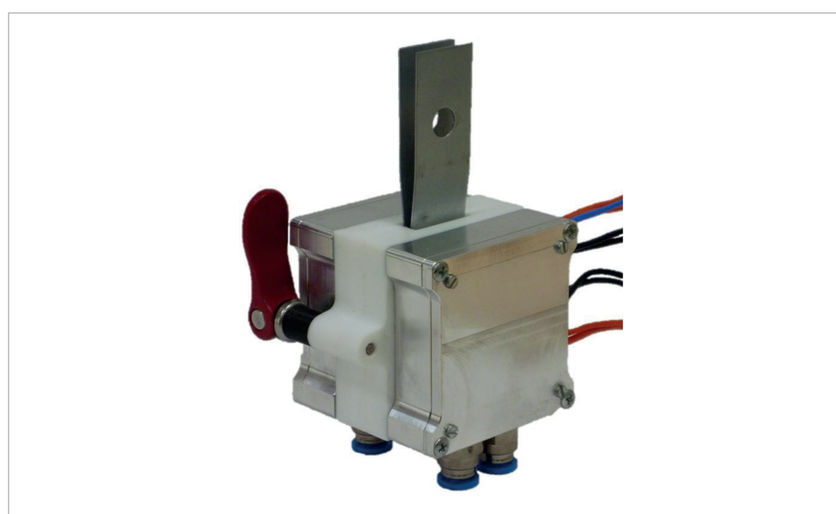
2 | Temperiereinheit mit eingelegter Versuchsprobe
