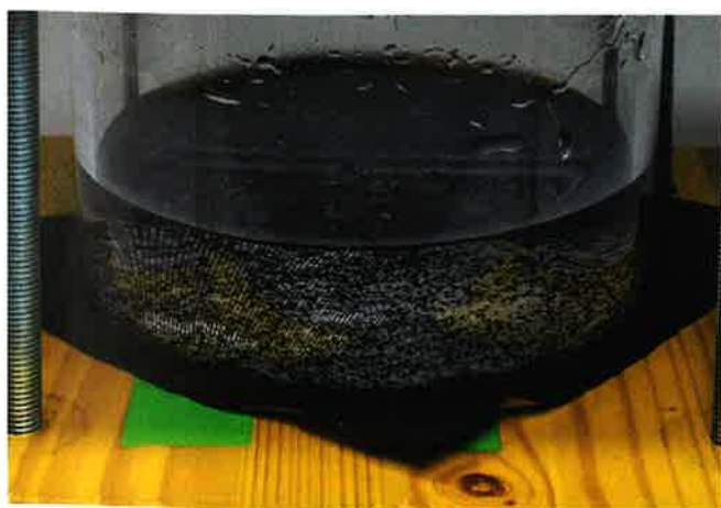
Abb. 1: Elution von der Prüfkörperoberfläche mit deionisiertem Wasser; links: EPDM, rechts: FPO
