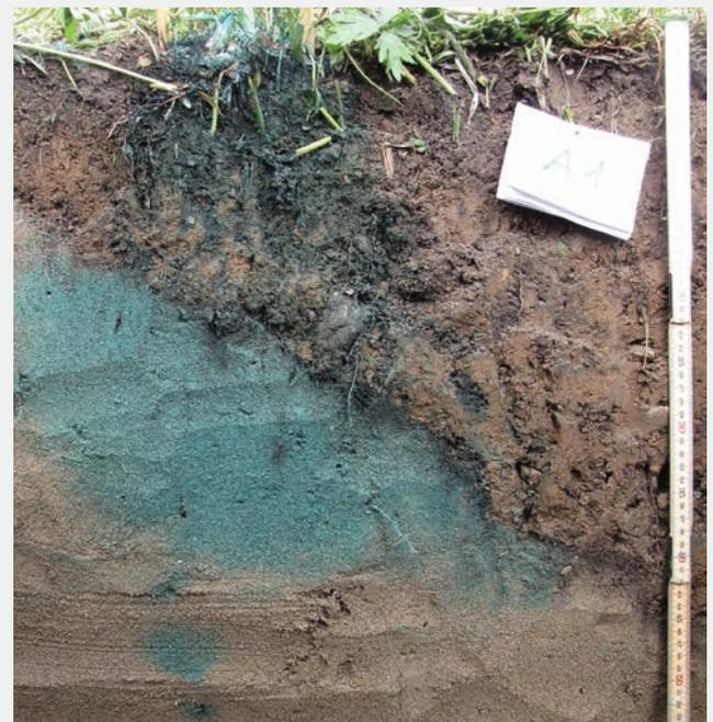
*Fig. 2* Verlagerung von Pneuabrieb und Farbtracer (Brilliant Blue) in einer Strassenabwasserbehandlungsanlage (SABA), in der Bodenmaterial oberhalb einer schräg verlaufenden Sandschicht eingebaut war [30].
