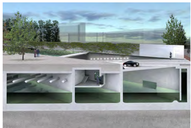
Abb. 69: Schematischer Schnitt der Tiefgarage mit Retentionsvolumen
