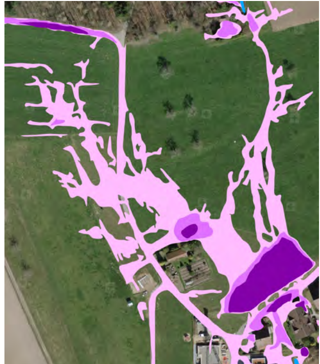
Abb. 25: Gefährdungskarte Oberflächenabfluss beim eingedolten Buechbach: blau die offenen Abschnitte; grosse, dunkelviolette Fläche unten rechts das Rückhaltebecken
