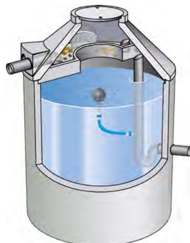
Abb. 79: Zisterne mit Retentions- und Speichervolumen
