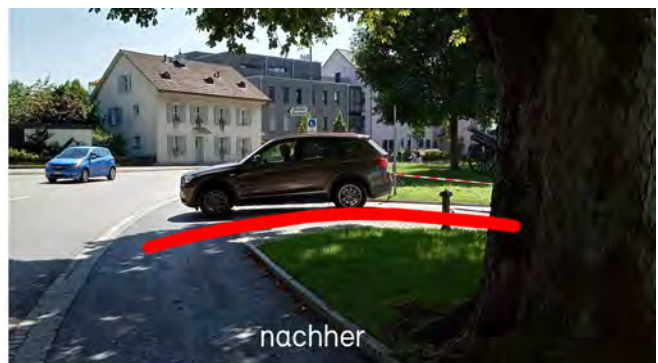
Abb. 32: Schutz der Zofinger Altstadt vor Oberflächenabfluss durch Bombierung der Strasseneinmündung Gefälle vor (Bild links) und nach der Anpassung (rechts)
