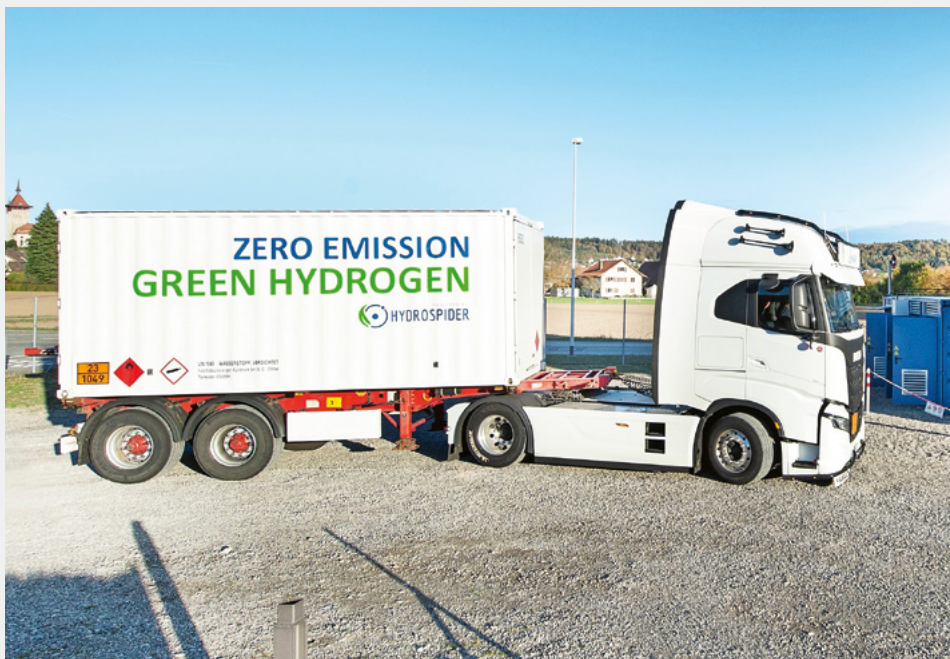
Fig. 3 Containers utilisés par Hydrospider AG pour transporter l'hydrogène de la production aux stations-service. (© Hydrospider/Jean-Luc Grossmann )
