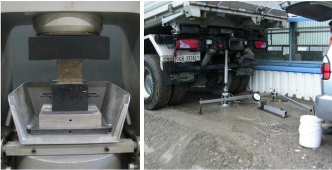
Abb. 1: Festigkeitsbestimmung beim Prüfkörper im Labor und Messung des ME-Wertes in einem Feldversuch.
