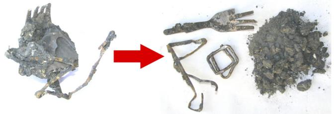
Abb. 3: Eingeschlossene Metallstücke (links) und von der Schlacke freigelegte Metallstücke (rechts).
