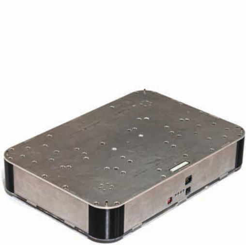
Modulares Fahrwerk (links) zum Transport von Bauteilen in der Mikrologistik; Bsp. eines UTZ-Stapelbehälters (rechts) Eigene Darstellung
