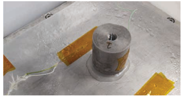
Angefrorener Prüfkörper auf Spannplatte mit befestigten Thermoelementen für die Temperaturüberwachung Eigene Darstellung
