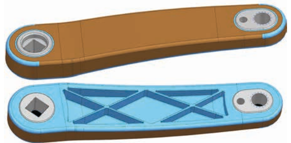
Composite-Bike-Kurbel, Ansicht von vorne und hinten Eigene Darstellung
