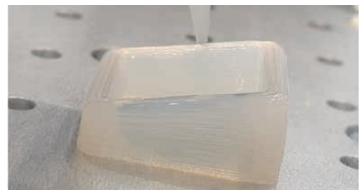
Druck eines gekrümmten Vierkantrohrs mit Silikon Eigene Darstellung
