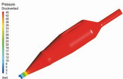
Strömungssimulation: Darstellung des theoretischen polymeren Schmelzdrucks, im Inneren des Werkzeugs Eigene Darstellung
