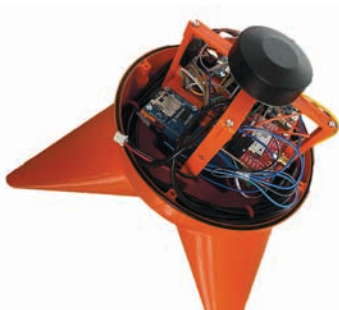
(Halb) Funktionsmuster von AvaNode 2.0 Eigene Darstellung
