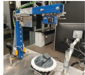
Messarm mit den beiden Lichtschnittsensoren und Linearachsen + Kalibrierkörper auf dem Drehteller Eigene Darstellung
