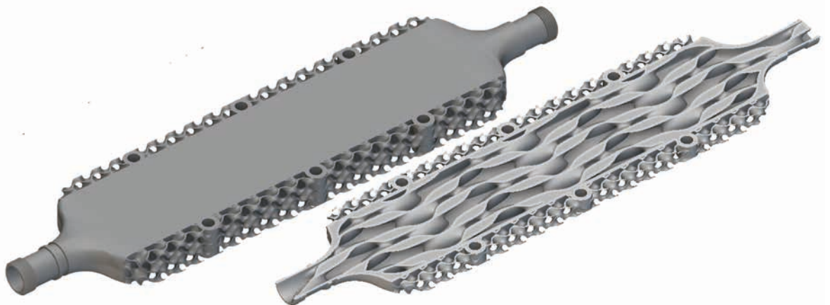
Optimierter Kühler, produktionsbereit und im Höhenschnitt Eigene Darstellung
