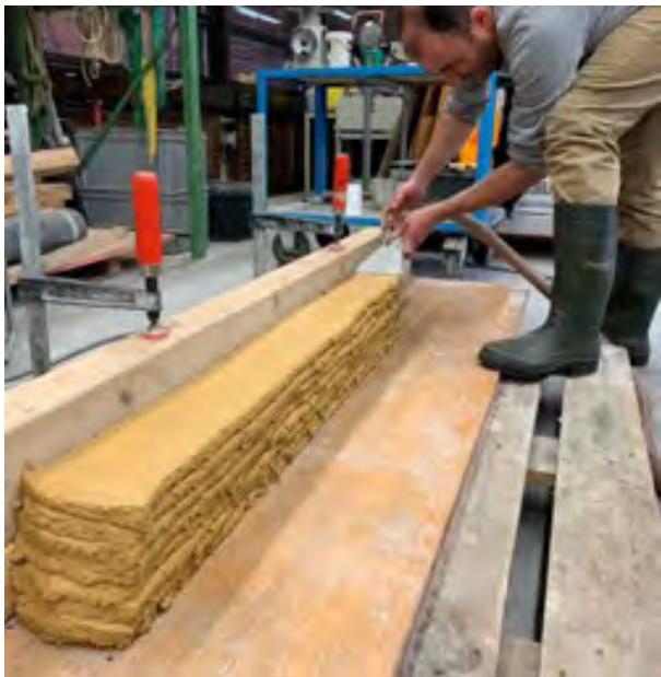
3D-Printing einer lehmbasierten Mischung. Quelle: Ivan Markovic
