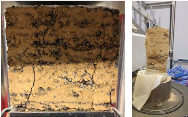
Würfeldruckversuch (links) und Triaxialversuch (rechts). Quelle: Michele Demarchi
