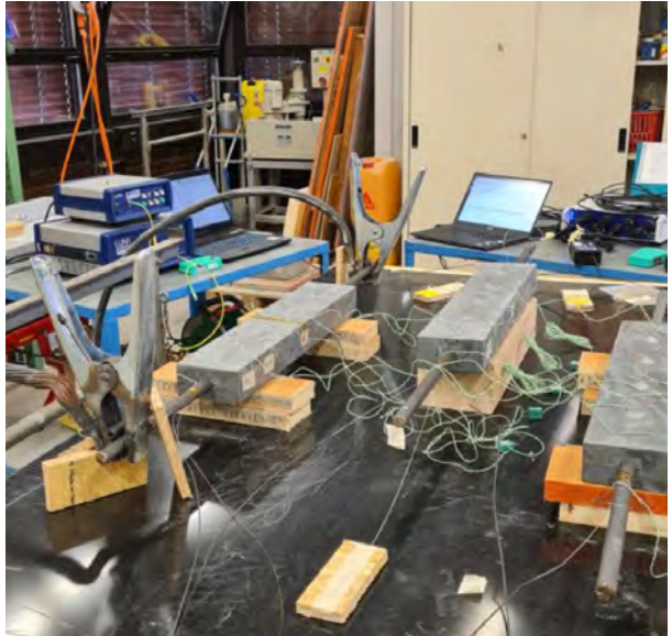
Messungen der Interaktion zwischen memory-Steel-Bewehrung und UHFB mit optischen Fasern (DFOS). Quelle: Stefan Thoma (FH OST)
