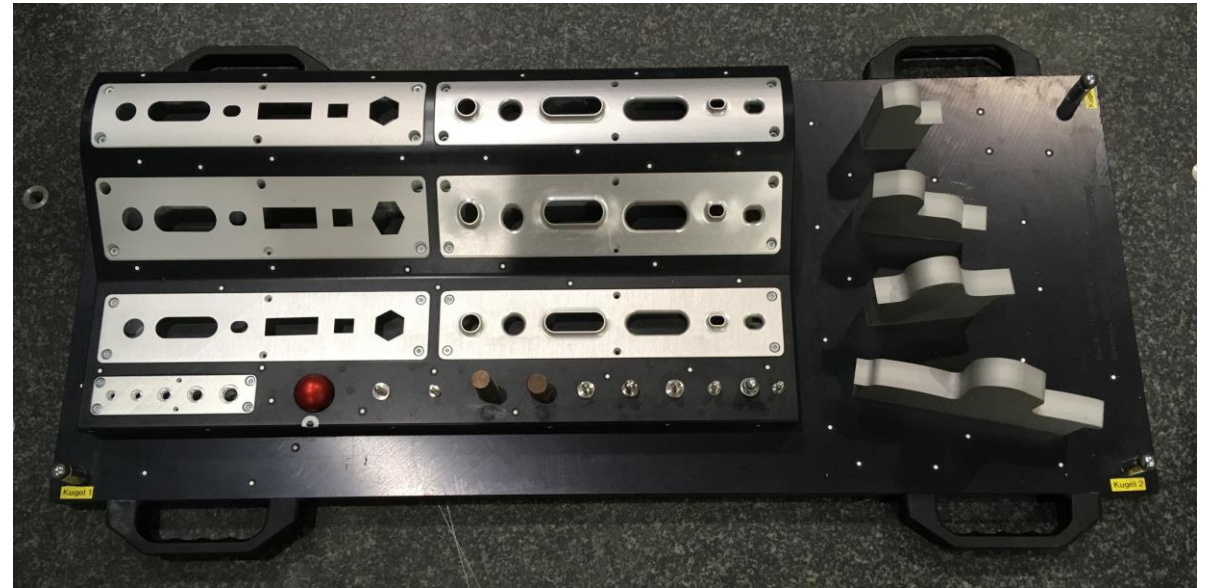
Kalibriertes Reverenz-Normal („Featureplatte“)
