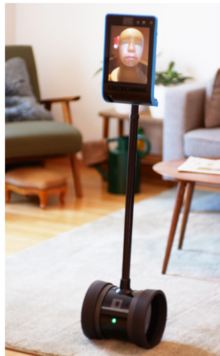
Oben: Das Wohnzimmer bietet Aufstehsessel, veränderbares Licht und eine Gaming-Zone (Teppich). Rechts: ein normaler Flur – mit Ortungsgerät, Assistenzsystemen für verschiedene Alarmer und digitalem Bilderrahmen. Unten: Ein Double-Roboter bietet Telepräsenz und kann per Navisystem selbständig zu gesetzten Zielpunkten fahren.
