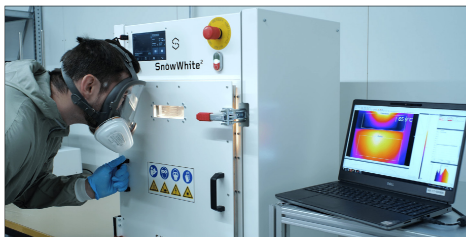
Bild 2: Mit Forschungsmaschinen lässt sich die Verarbeitung der ausgefällten Pulver im SLS-Verfahren testen.
