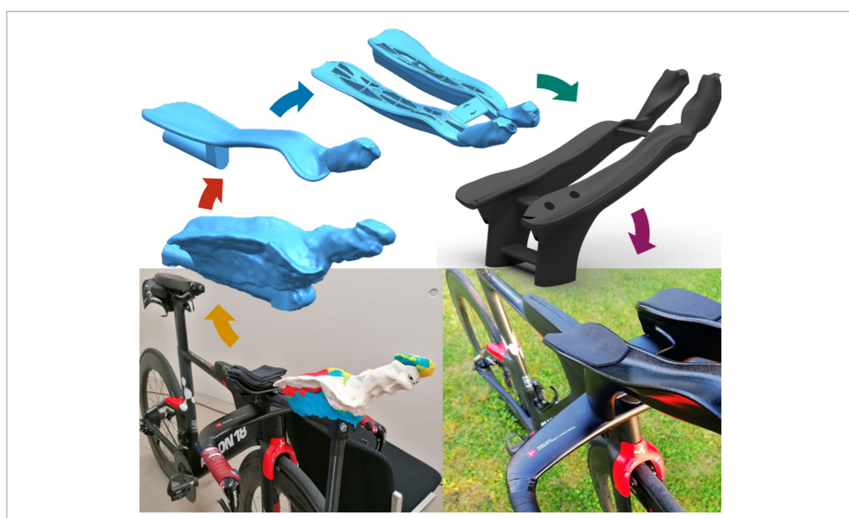
3 | Vom Model, über den Scan, die Daten Rückführung ins CAD zum individualisiertem Bauteil am Beispiel AeroBar
