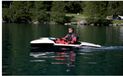
Bild 4. Erste Versuche, um das Fahrverhalten zu testen, zeigten: Bei geringer Geschwindigkeit (< 15 km/h) liegt das Boot ganz im Wasser (links), bei ungefähr 15 km/h hebt es sich teilweise aus dem Wasser (Mitte) und bei Geschwindigkeiten größer 15 km/h ist der Bootsrumf über dem Wasser (rechts); gut zu erkennen ist auch, dass weniger Wasser aufgewirbelt wird – d.h. wenig Verlustleistung tritt auf
