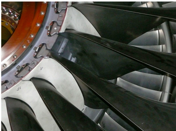
Der neue Annulus Filler für Strahltriebwerke von Rolls Royce. (Bild: IWK)
