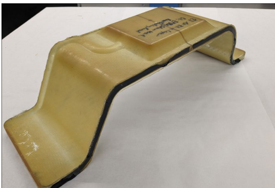
Abb. 1: RTM-Demonstrator-Bauteil: Battery Casing für ein Elektrofahrzeug (Bilder: IWK)
