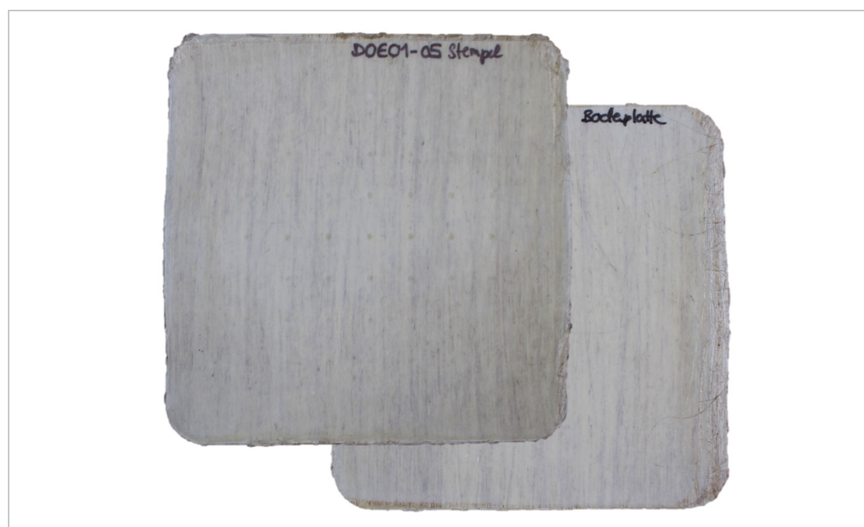
2 | Bulk-Cellulose-Verbundwerkstoffplatte aus unidirektionalem Flachfaser-Tape und mikrofibrillierter Cellulose als Matrix.
