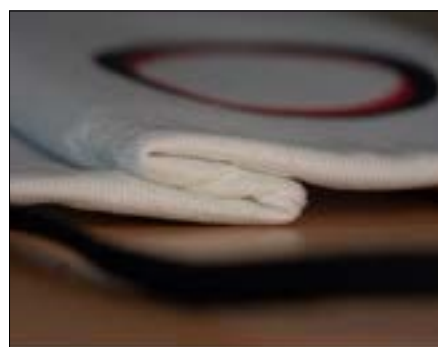
Bild 3: Die reaktive Schmelzklebefolie hält die gefaltete Atemschutzmaske für einen optimalen Tragkomfort zusammen (Semesterarbeit S. Deola HS 20)
