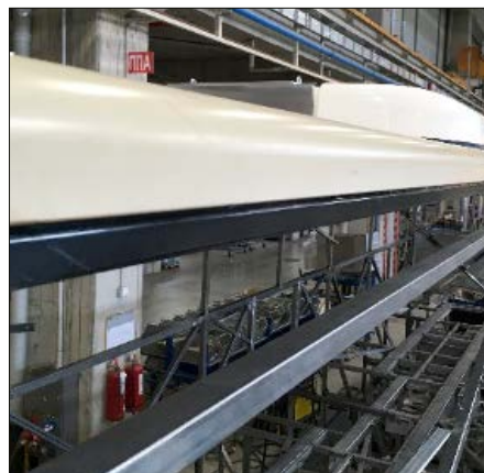
Bild 3: Viskoelastische Dickschicht-Verklebung der Unterseite eines vormontierten Busdaches mit dem Klebstoff SikaForce Powerflex [2]
