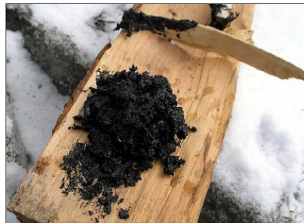
Bild 1: Im Eintopfverfahren hergestelltes Birkenpech [1]
