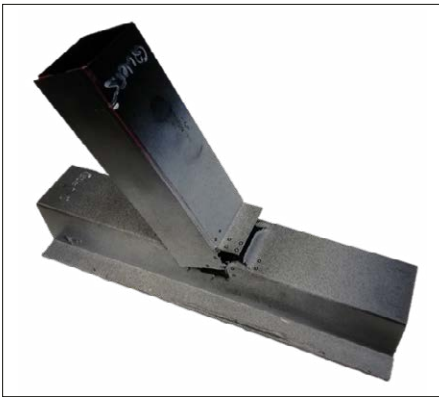
Bild 6: Validierung des mechanischen Verhaltens einer strukturellen Klebverbindung unter stossartiger Belastung, anhand Digital Twin einer T-Stoss Fallstudie
