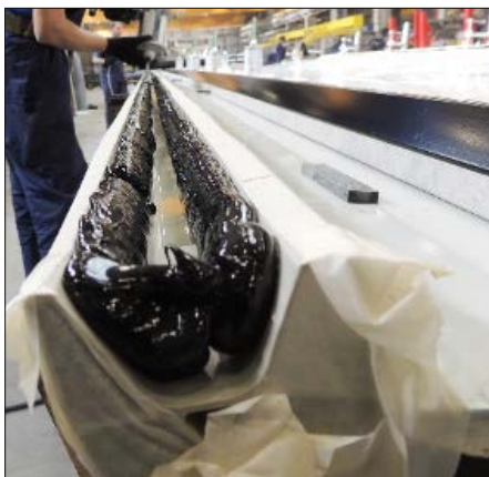
Bild 3: Viskoelastische Dickschicht-Verklebung der Unterseite eines vormontierten Busdaches mit dem Klebstoff SikaForce Powerflex [2]
