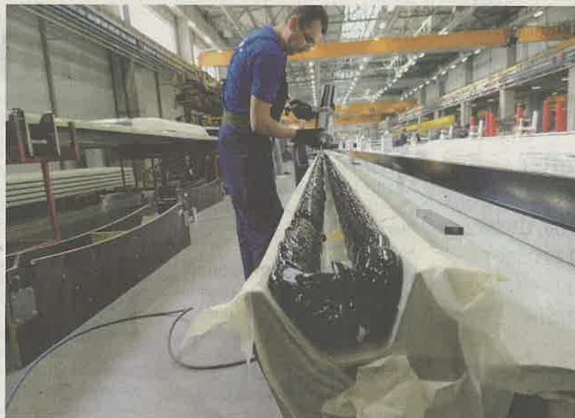
Schnelle Montage: Der Klebstoff wird an der Unterseite eines vormontierten Busdaches aufgebracht.
