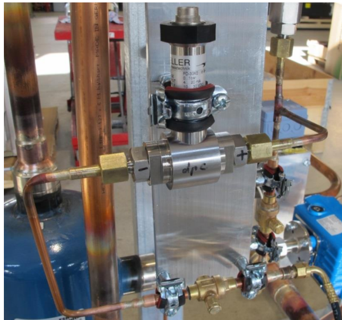
Abbildung 75: Montage der Drucksensoren (Messstelle \Delta p_c als Beispiel)
