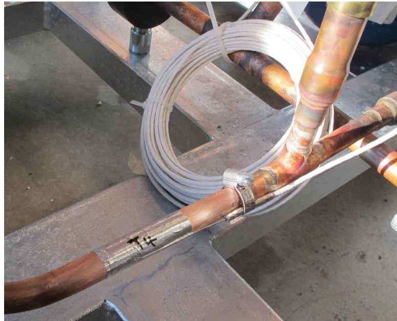
Abbildung 74: Montage der Temperatursensoren auf der Prozessseite vor Isolation (Messstelle T_4 als Beispiel)
