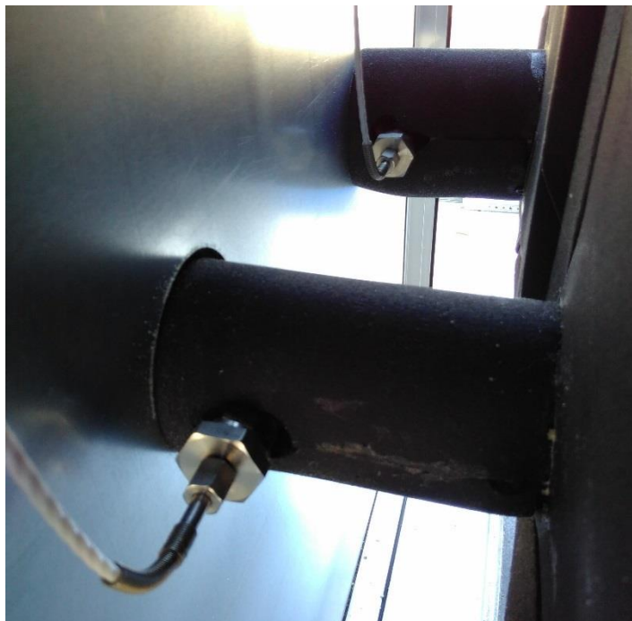
Abbildung 77: Montage der Temperatursensoren auf der Hydraulikseite (Messstellen T_{CE} und T_{CA} als Beispiel)
