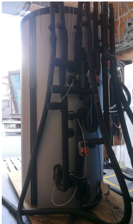
Abbildung 7: Speicher auf dem Prüfstand des SPF. Alle Anschlüsse sind siphoniert und isoliert. Die Temperaturmessung erfolgt so nahe am Speicher-System wie möglich
