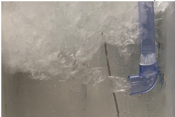
Abbildung 2: Einströmender Eisbrei im Wassertank.
