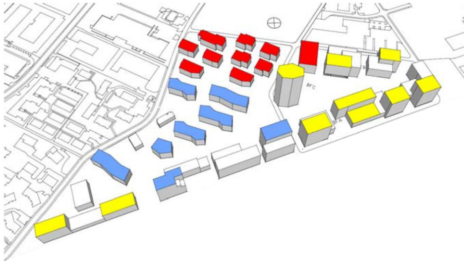
Abbildung 35: Übersichtsschema des Areals Suurstoffi mit den für die solare Energienutzung genutzten bzw. vorgesehenen Dachflächen. Die Gebäude mit blauen und roten Dachflächen sind bereits gebaut und in Betrieb, wobei die blauen Dächer mit PV-Modulen und die roten mit PVT-Kollektoren bedeckt sind. Die Gebäude mit gelben Dachflächen wurden noch nicht gebaut und sollen gemäss aktueller Planung mit PVT-Kollektoren ausgestattet werden. (Bild: Abgeändert aus Ref. [26]).
