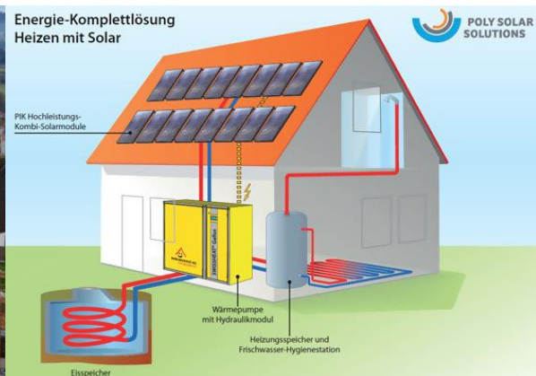
Abbildung 54: Ansicht eines der Mehrfamilienhäuser der Überbauung „MFH Freihof“ in Andwil mit schematischer Darstellung des Wärmeversorgungssystems (Bilder: Bion Bauhaus AG, Poly Solar Solutions AG).
