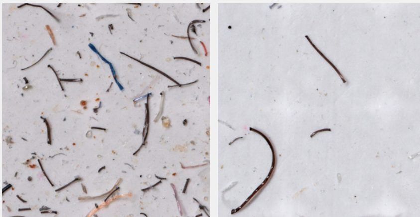
Fig. 3 Verteilung der Mikroplastik-Fasern und -Partikel der ersten (links) und zehnten Hauptwäsche (rechts) von Fleece-Wäsche.
