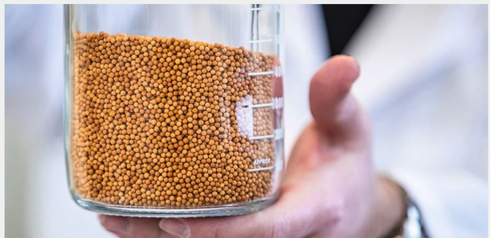
Fig. 2 Sphärische Pellets des Eisen-Katalysators, bestehend aus dem Trägermaterial Zeolith, das mit Partikeln aus dotiertem Eisen versehen ist. Das Eisen ist der eigentliche Katalysator der Methanisierungsreaktion. (Foto: OST)
