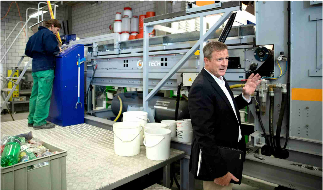
Professor Rainer Bunge erläutert die Funktionsweise des Sensor-Abscheiders. Die Maschine analysiert den Abfallmix und sortiert danach wertvolle Bestandteile wie Leiterplatten aus. Fotos: Dominique Meinerberg
