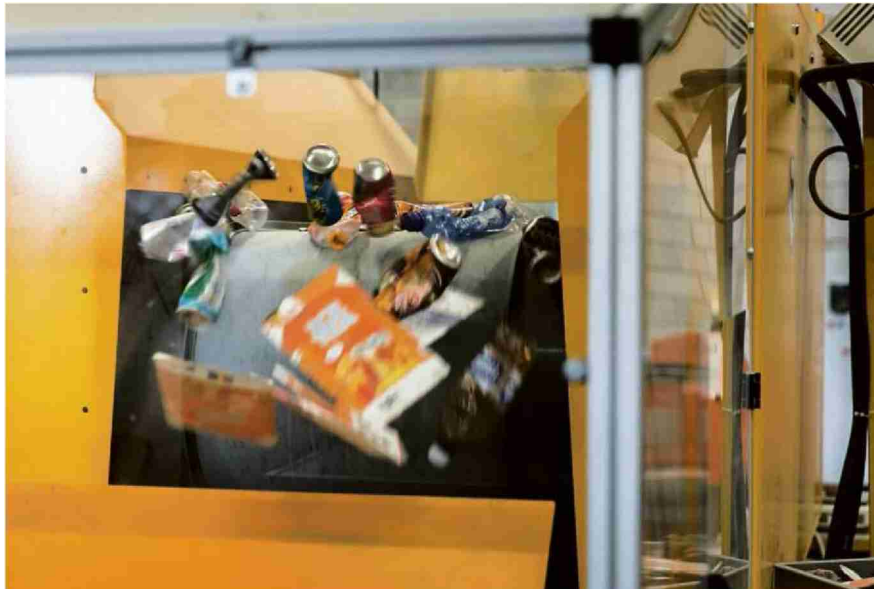
Ein Wirbelstrom-Abscheider in Aktion.
