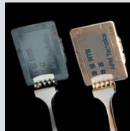
PMMA-Bauteil mit strukturiertem Antifog-Lack (links) und Wasserkon- densation auf einer unbeschichteten PMMA-Oberfläche (rechts).
