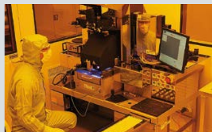
Der neue Maskaligner im Reinraum des MNT im Einsatz.
