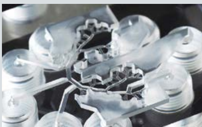
Der vom MNT entwickelte Herzgefässe-Mikrochip (2. Generation).
