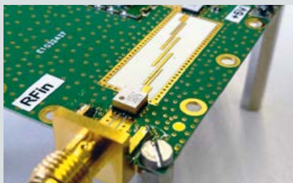
10-GHz-Bandpassfilter mit 1GHz Bandbreite.
