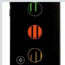
Aufnahme von PWM-modulierten LEDs zeigt Bänder, welche dem zeitlichen Abbild der Modulation entsprechen.
