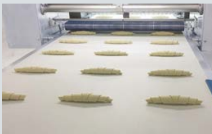
Dreibahniger Betrieb des Cromasters nach der Ausrichtung der Croissants.
