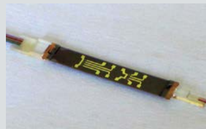
Fasergekoppeltes Wellenleiterboard mit acht Schaltern (Bauteilbreite 5 mm).
