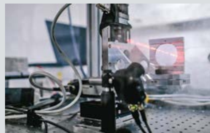
Prüfplatz zur Ermittlung der Laserzerstörungsschwelle optischer Schichten.
