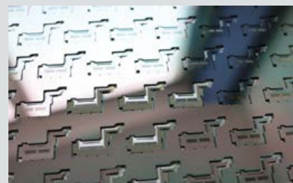
Waferschnitt mit einzelnen Kraftsensorchips (Chipfläche ca. 40 mm 2 ).
