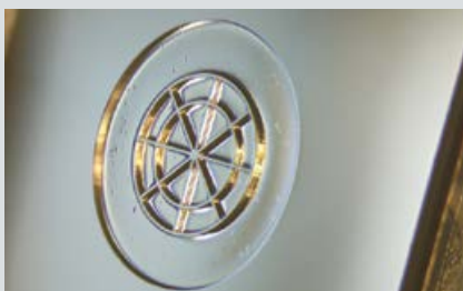
Mikrosystemtechnisch hergestelltes Mikrofon (Durchmesser 8 mm).
