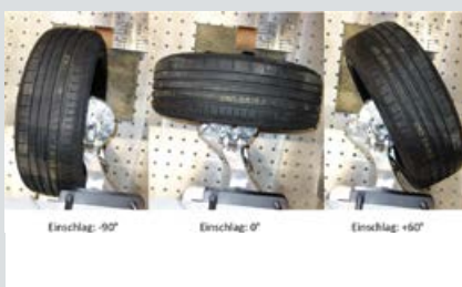
Einzelradlenkung mit Einschlagwinkel von -90^\circ bis +60^\circ .
