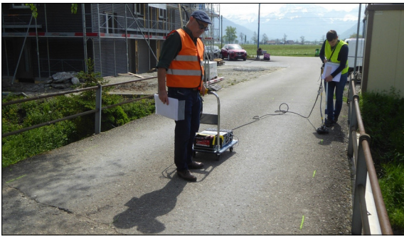
Zustandserfassung der Brücke mittels Georadar Eigene Darstellung
