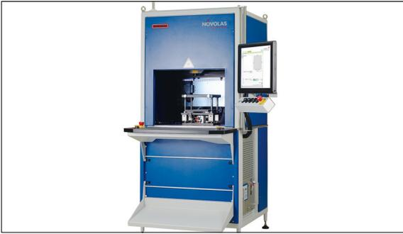
Abbildung 1: Laserdurchstrahlsschweissen Anlage, Novolas WS-AT der Firma Leister
