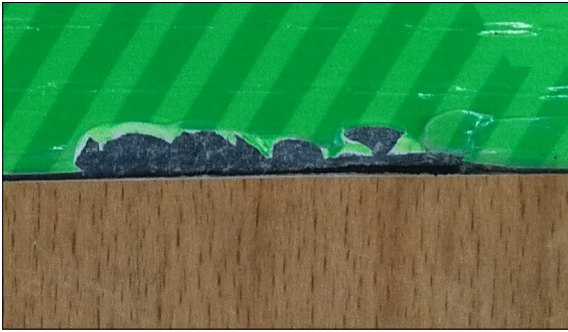
Bruchstelle, bei der ein Teil des Top-Sheets delaminiert und entfernt wurde.
