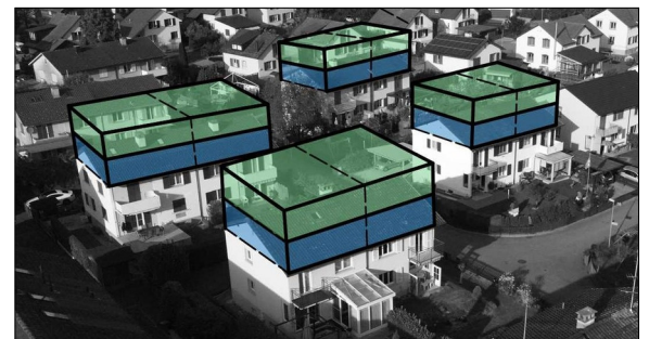
Einfache Visualisierung von potentiellen Aufstockungen auf Doppel-Einfamilienhäusern um zwei Geschosse (blau & grün). Eigene Darstellung
