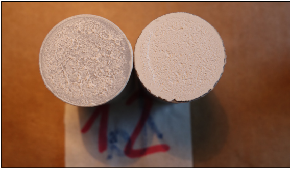
Bruchbild einer Standardzugversuchsprobe mit 3in1 Lack, rein kohäsiv in der Lackschicht gebrochen
