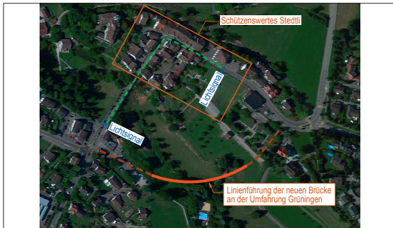
Ausgangslage und Linienführung der Brücke (rote Linie)
