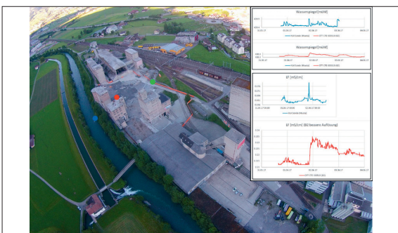
Wassermessungen am linken Muota-Ufer; rechts Erstauswertung Pegel, Leitfähigkeiten (OW blau: HL4 Sonde, GW rot: Ott CTD Sonde (Abstand ca. 60 m))
