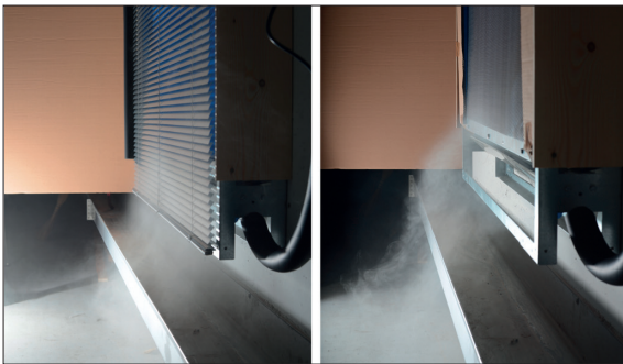
Strömungsverlauf der Kaltluft bei unterschiedlichen Kühlschacht-abdeckungen
