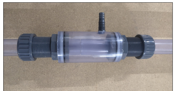
Abb. 3: Aufbau des Prototyp 1 mit Schraubverbindung und Schlauchtülle Eigene Darstellung
