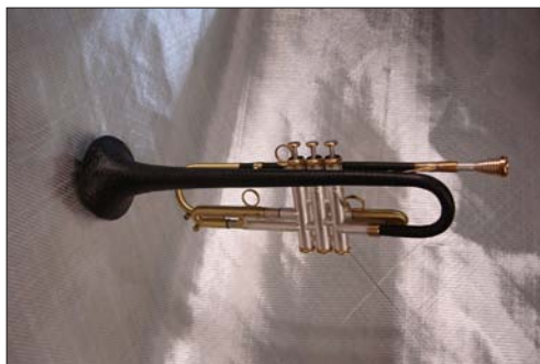
Handlaminiertes Schallstück an einer Originaltrompete
