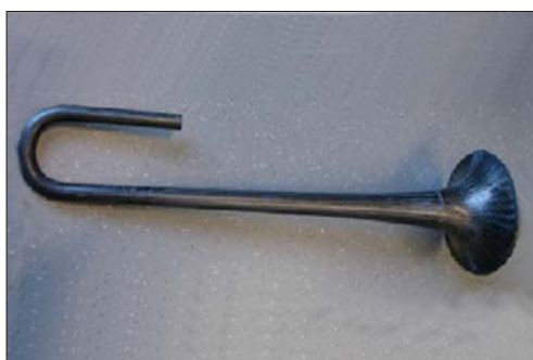
Schallstück, hergestellt im RTM-Verfahren
