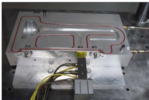
RTM-Werkzeug für die Fertigung des Faserverbundschallstücks
