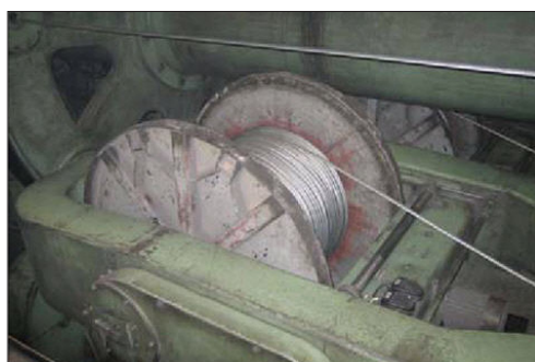
Litzenpule, die für eine gleichbleibende Litzenspannung gebremst werden muss
