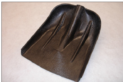
Lawinenschaufel, hergestellt aus einer mit MPT abgelegten Preform
